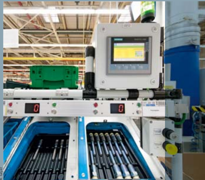
Zur Visualisierung an den Lagerplätzen dienen Simatic Comfort Panels
